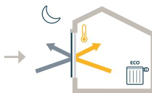
Le **schermature solari** sono **chiuse** per mantenere il **calore all'interno**.
