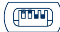
TIMEOUT OFF (attesa segnale da microswitch waiting for microswitch signal vedere - see pag 12)
