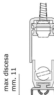
**Funzione:** chiusura automatica della fessura tra porta e pavimento per eliminare spifferi d'aria, infiltrazioni di polvere, insetti, fumo e per ridurre il passaggio di rumore
